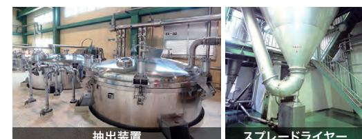
大型の抽出装置や、スフレードライヤー（噴霧乾燥装置）を複数有し、品質の安定したエキスピーバーを多種製造しています。
