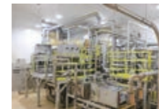
短時間殺菌可能な高速気流式殺菌装置
