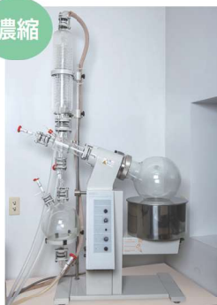
10L濃縮機： 蒸発量3.5L/hr
